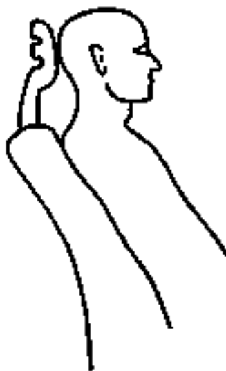
Figur 2: Teckningen illustrerar att nackstödet förhindrar den initiala översträckningen som ses i figur 1. Däremot kan huvud och kropp kastas framåt.
